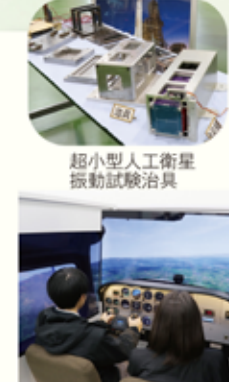
超小型人工衛星 振動試験器具
